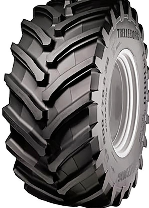
pneus e rodas completas para veículos fora de estrada, como máquinas agrícolas, movimentação de materiais, veículos de construção e aplicações especiais.
